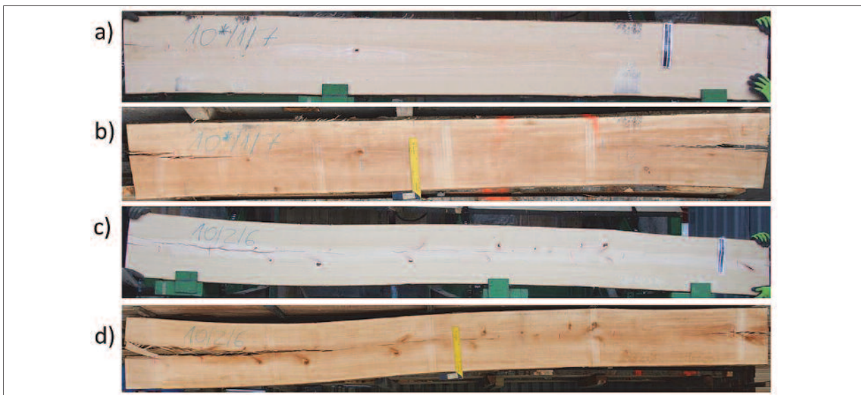
Slika 6. Izgled žaganic pred (a, c) in po postopku (b, d) tehničnega sušenja: a) žaganica B-kakovosti pred sušenjem, b) ista žaganica po sušenju, razvrščena v C-kakovostni razred, c) žaganica C-kakovosti pred sušenjem, d) ista žaganica, razvrščena v les za predelavo (P) po sušenju
